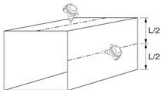
Abb. 3 Quadratischer Querschnitt, mittig auf der Leitung oder seitlich
