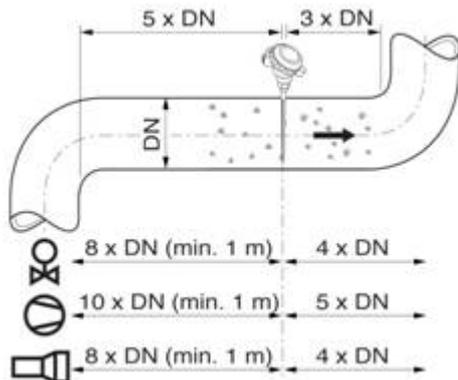
Abb. 1 Empfohlene Distanzen zu Ventilen, etc. (DN = nominaler Durchmesser)
