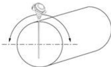
Abb. 2 Runder Querschnitt, in der horizontalen Achse
